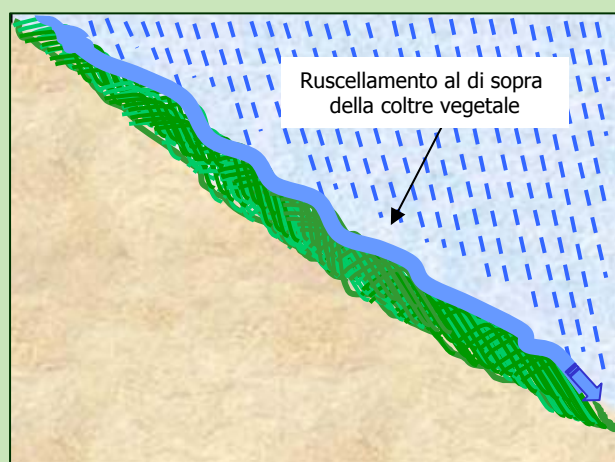
Ruscellamento dell'acqua meteorica dovuta a eventi piovosi intensi al di sopra della coltre erbacea allettata
