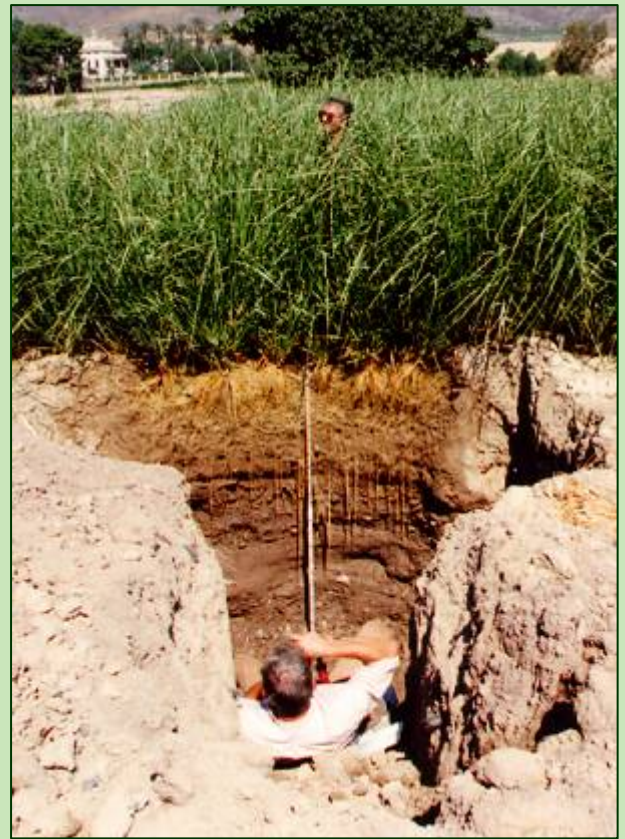
Scavi per verificare profondità e distribuzione radicale
