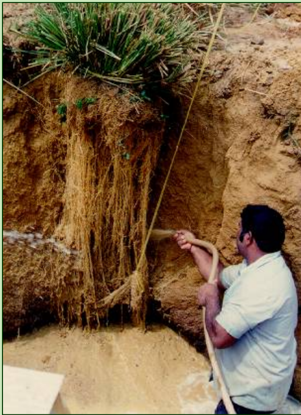
Scavi per verificare profondità e distribuzione radicale
