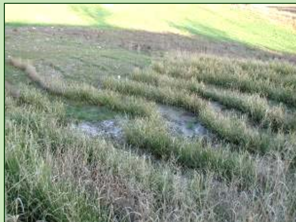
Il sistema terreno-radici deformato resiste alle spinte delle argille liquefatte
