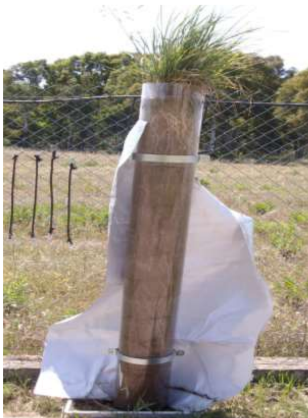
Figura 7 – Verifica di accrescimento radicale nel substrato fortemente inquinato da metalli pesanti (valori riportati in figura 4). Fonte: prati armati
