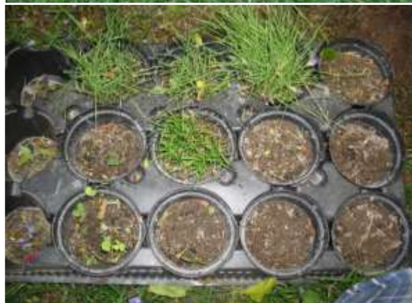
Figura 9 – Prove di germinazione su terreno contaminato da idrocarburi: a) al momento della semina; b) a germinazione e accrescimento avvenuti. Fonte: prati armati
