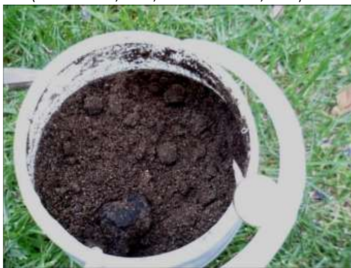
Figura 8 – Suolo inquinato da idrocarburi in concentrazione 4.150 ppm prima della semina. Fonte: prati armati
