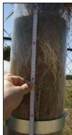
**Figura 2.** Tubo di prova utilizzato per le prove di radicazione e particolare dell’apparato radicale dei prati armati
