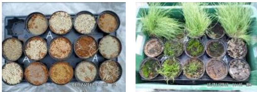
**Figura 4.** Test di germinazione sui fanghi rossi prima della semina e dopo un mese dalla semina di prati armati
