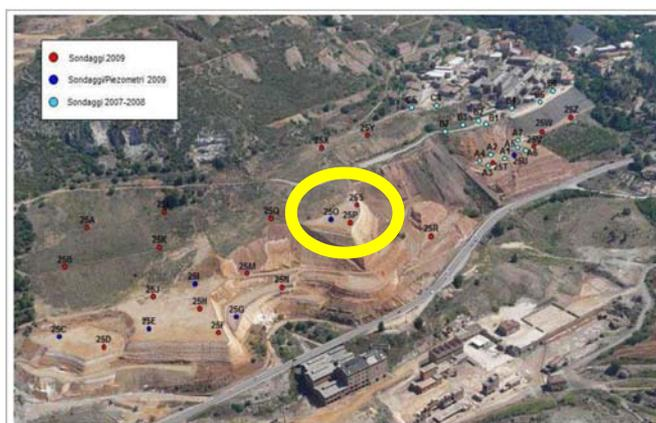
**Figura 3.** Ubicazione dei sondaggi di fanghi rossi. Nel cerchio giallo i siti di prelievo dei campioni utilizzati per i test di germinazione
