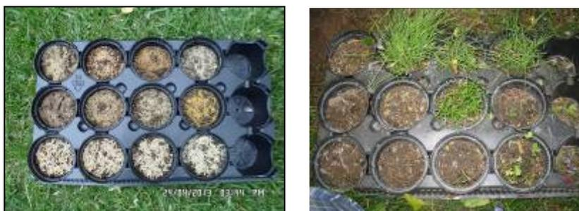
**Figura 5.** Test di germinazione su suoli inquinati da idrocarburi prima della semina e dopo 20 giorni dalla semina di prati armati
