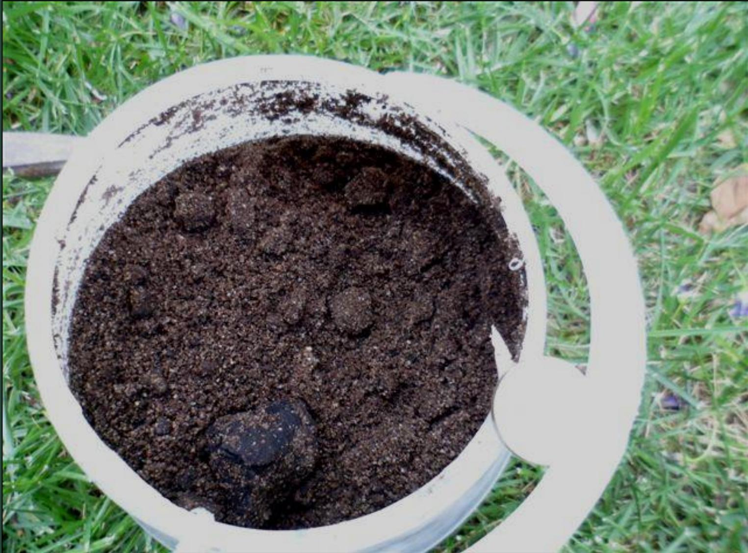
Campione di terreno inquinato da idrocarburi. Campione con 4150 ppm di idrocarburi totali prelevati da area contaminata in un complesso petrolchimico. Limiti di legge 1000 ppm
